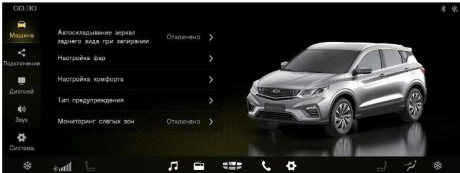
Автоматическое складывание зеркал после запирания дверей автомобиля: функция активирования или деактивирования автоматического складывания зеркал после запирания дверей автомобиля.
